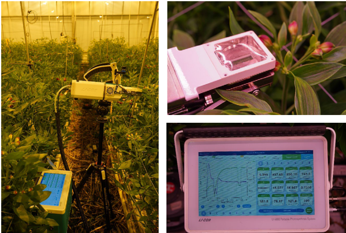
Figuur 7 Metingen fotosynthese. Links de Li-Cor tijdens de meting. Rechts boven, detail gesloten kop; rechts onder, detail display.
