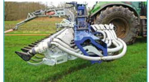
Dankzij het C profiel en de bevestiging van de elementen aan de voorzijde komt het zwaartepunt zeer dicht op de trekker.
