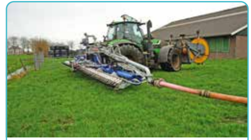
De bemester kan worden uitgerust met een 'normale' sleepbuis, maar ook met de Slurry Swivel waarbij de slang altijd over de bemester gaat en je 180 graden bochten kunt maken.
