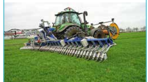
Door het werken met losse elementen met een grote slag heeft deze Slurry injector een zeer goede bodemvolgving.
