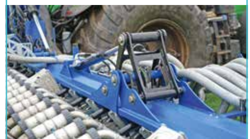
De bemester heeft brede scharnierpunten, die voor voldoende stevigheid moeten zorgen. Bij het uitklappen is er een extra automatische pen-gat-vergrendeling.
