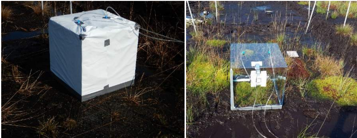
Figuur 26. Foto van de lichtdichte fluxkamer (links) voor de donkermetingen aan de fluxen van CO 2 en CH 4 en de doorzichtige kamer voor de lichtmetingen. De fluxkamer is voorzien van een ventilator om de lucht binnen de kamer te mengen. Foto's: Hilde Tomassen en Thomas Gremmen.
