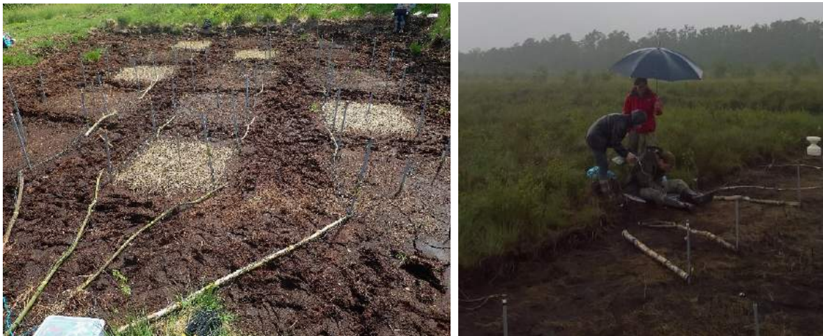
Figuur 24. Impressie van aanvullende metingen aan oppervlakkig vochtgehalte en bodemtemperatuur in het plas-dras experiment. Links: proefvlakken met sensorkabels beschermd door berkenstammetjes. Rechts installeren datalogger sensornetwerk met op achtergrond een regenmeter. Foto's: Mark Rademaker (links, 2018) en Esther Brakkee (rechts, 2018).
