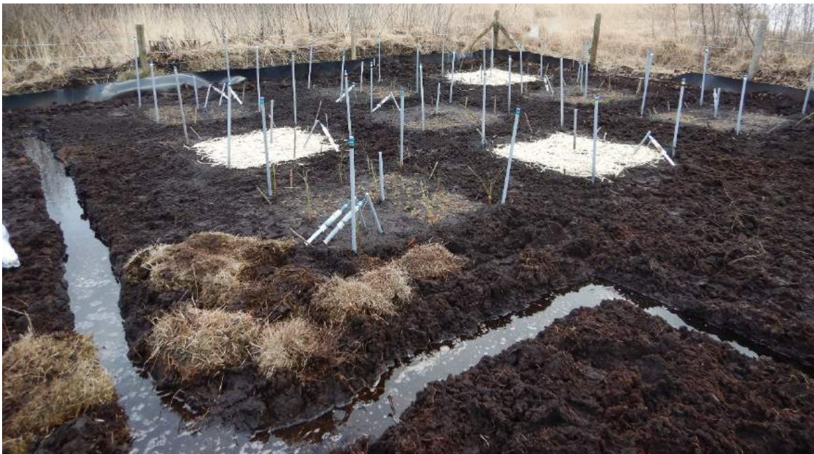
Figuur 17. Om de infiltratie van opgepompt water in veen te versnellen en om een gelijk effect binnen het gehele compartiment te bewerkstelligen werden in de compartimenten met een gecontroleerd peil ondiepe greppels gegraven. Op de foto de situatie in het Haaksbergerveen na opnieuw inrichten van het 'plas-dras' experiment. Foto: Hilde Tomassen.
