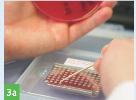
3a Identificatie van de kolonies met de MALDI Biotyper: aanbrengen van koloniemateriaal op MALDI-target.
