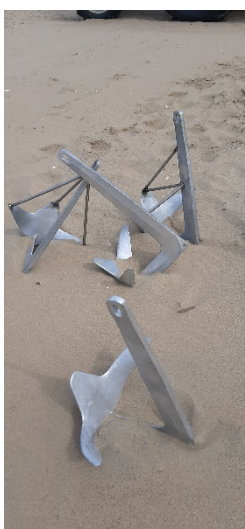
Figuur 2. Het standaard Bruce anker (A) en variant 1 (A, B) en variant 2 (B) van de aanpassingen van het Bruce anker.
