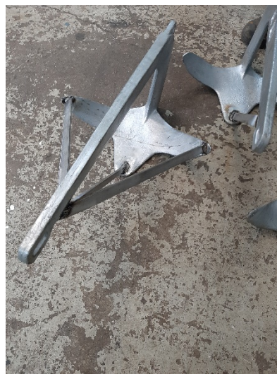
Figuur 2. Het standaard Bruce anker (A) en variant 1 (A, B) en variant 2 (B) van de aanpassingen van het Bruce anker.
