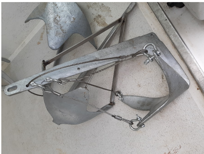
Figuur 3. Variant 4 van het Bruce anker: staakabeltjes met daaronder variant 1 van de aanpassingen.
