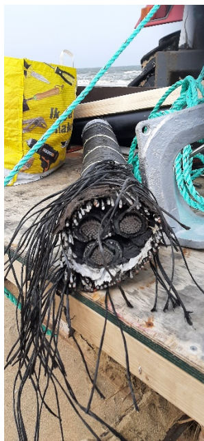
Figuur 1 de echte infield-electriciteitskabel met een diameter van 146 mm: de opbouw is van buiten naar binnen: 1. Raffia bedekking (zeer dun); 2. Dunne bitumen laag; 3. Gegalvaniseerde staaldraden; 4. Bitumen coating; 5. Drie elektriciteitskabels met een vergelijkbare opbouw als de gehele infield-electriciteitskabel.
