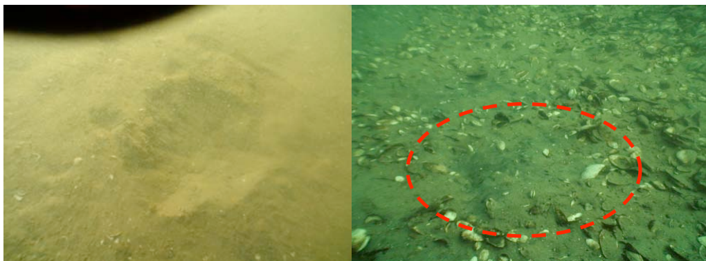
Afbeelding 3. Bodemhappen met de Van Veen happer op zand (links) en op schelpen (rechts). Op zand penetreert de happer aanzienlijk dieper dan op schelpen.
