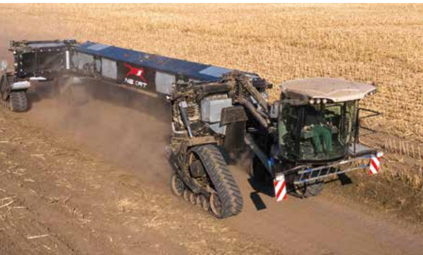
Hier de Nexat in transportstand zonder werktuigmodule. De Nexat blijft binnen een breedte van 3,50 meter, maar is wel circa achttien meter lang.
