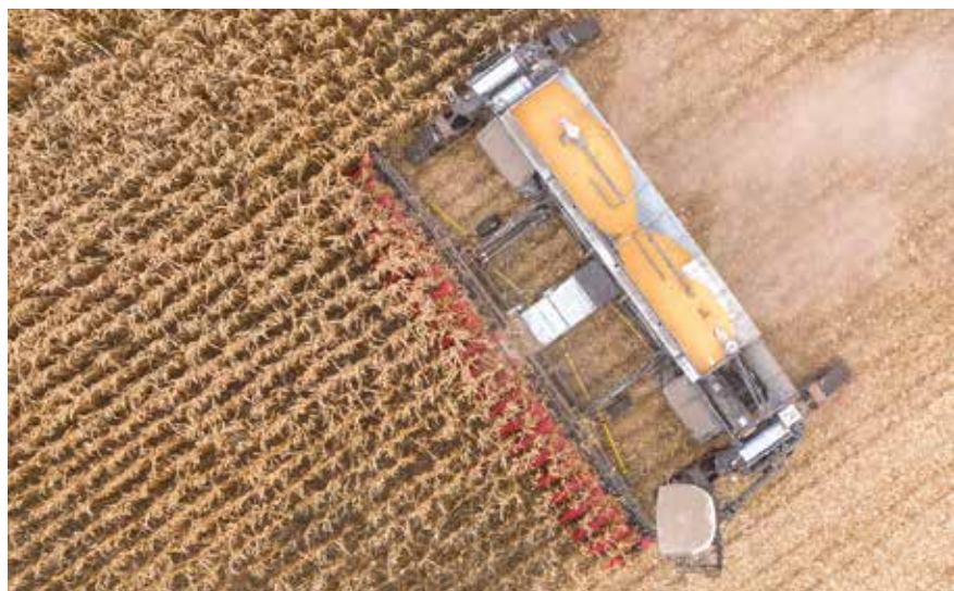
De NexCo-maaidorserunit met 36-kuubs graantank heeft een 5,80 meter lange axiaalrotor met een middeninvoer die tweezijdig werkt.
