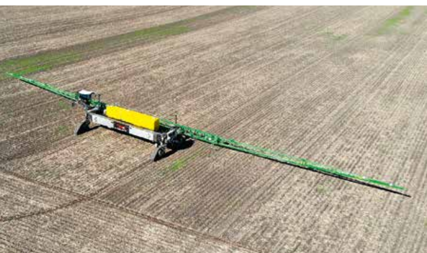
Passend in het concept ontwikkelde Dammann deze spuitunit met 70 meter brede spuitboom, goed voor vijf werkgangen.
