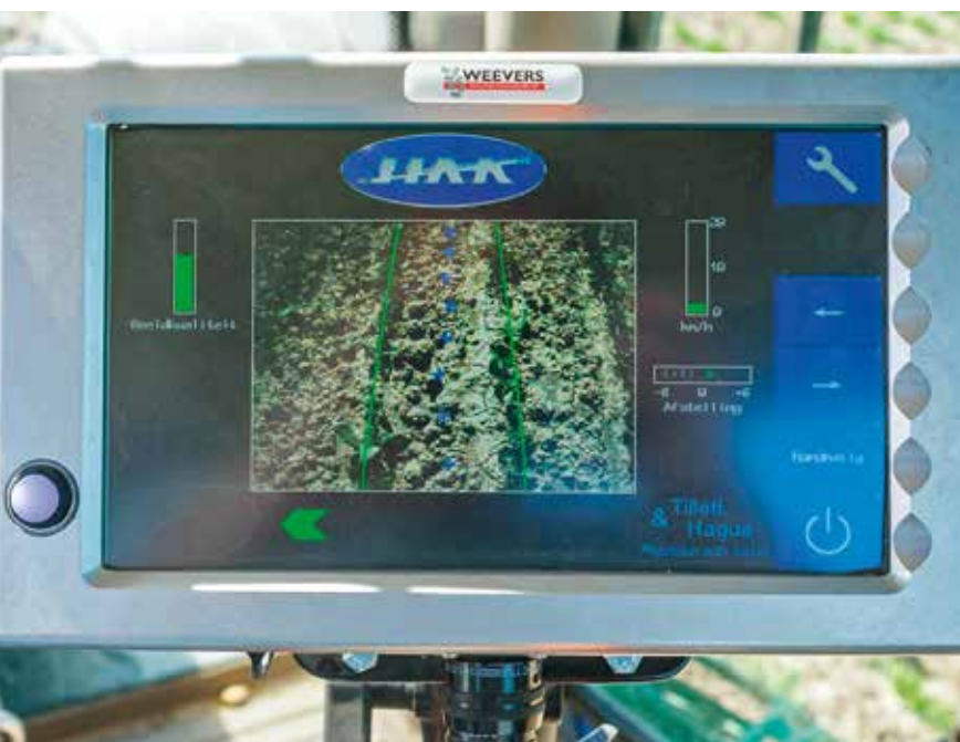
Een weergave van het beeld van de camera op de schoffel van HAK.
