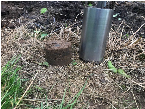
Figuur 22 Boren van grondmonsters om het vochtgehalte te bepalen.
