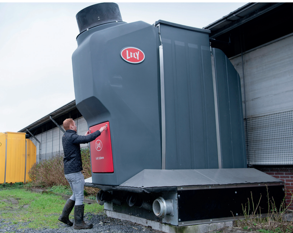
In de N-capture wordt ammoniak omgezet in vloeibare meststof
