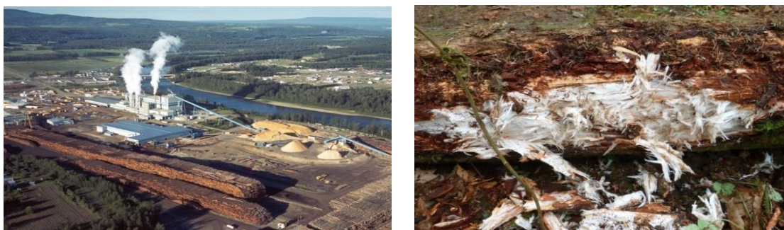
Figuur 1: man-made chemische pulping (links) vs. nature-made biopulping (rechts). Met als kenmerken respectievelijk: grote schaal, hoge temperatuur, korte behandeltime input van energie & chemicaliën, vs. kleine schaal, lage temperatuur, langere behandeltime, input / afbraak van lignine en hemicellulose.
