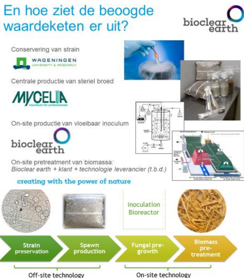
Figuur 6: de visie van Bioclear earth op de beoogde waardeketen voor biopulping. Off-site vindt de conservering van de benodigde schimmels en de productie van axenisch broed plaats. On-site wordt het broed verderd in inoculatie reactoren (seed-fermentor en productie-fermentor) waarna de biomassa wordt voorbehandeld op de plek waar deze vrijkomt en gebruikt wordt. Ook zou biomassa enzymatisch voorbehandeld kunnen worden met de in de bioreactor geproduceerde enzymen.
