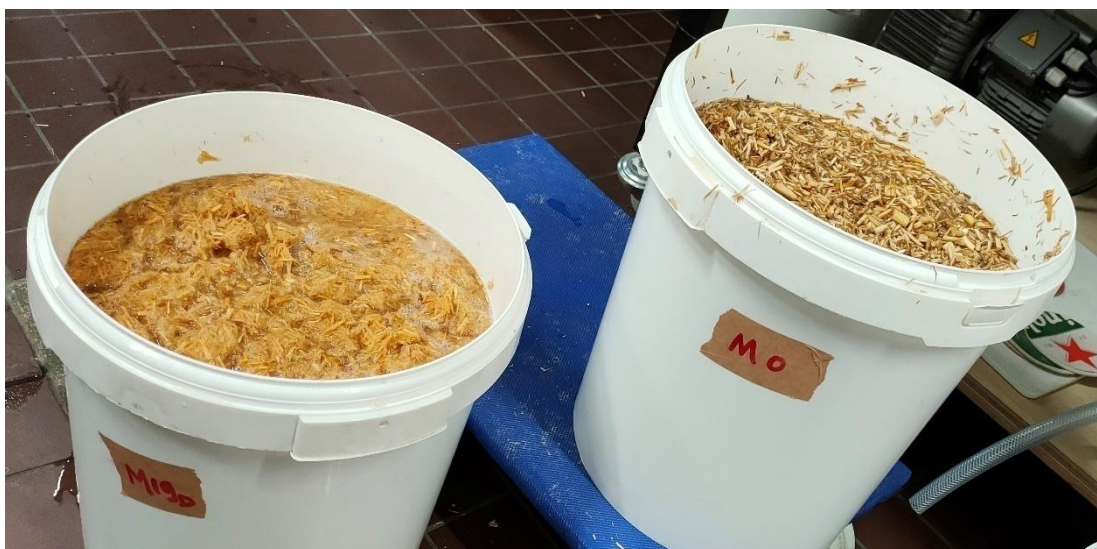
Figuur 17: Proof-of-principle van biopulping. Vervezeling van 'door biopulping behandelde Miscanthus strootjes t=19' (L) vs. vervezeling van 'niet gebiopulpte Miscanthus strootjes t=0' (R)
