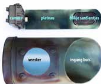
Het plateau met de camera en het lokmiddel wordt in de pvc-buis geschoven.
