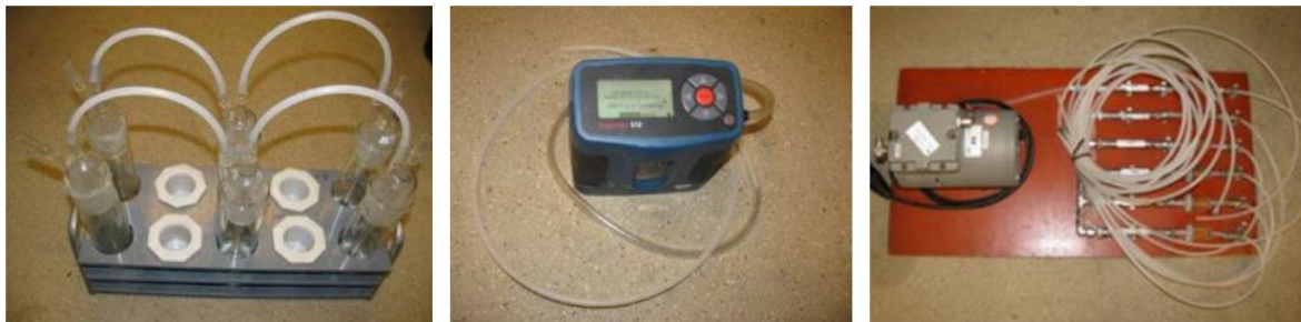
Figuur 2.3 Meetopstelling natchemische methode voor ammoniakbemonstering. Links: impingers. Midden: Flowmeter. Rechts: pomp met kritisch capillairen.
