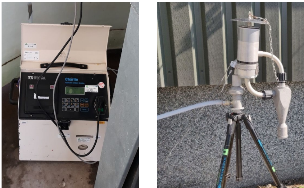
Figuur 2.5 Monsterapparatuur voor het meten van PM 10 d.m.v. gravimetrie. Links: detailfoto van de 'constant flow' pomp. Rechts: cycloonmeetkop voor gravimetrische meting van PM 10 .
