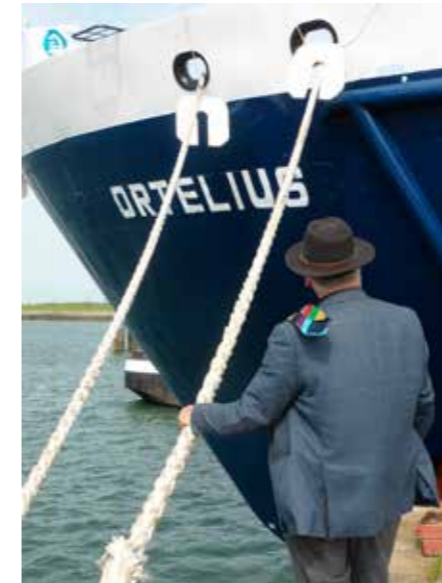
Het linker rattenschild is niet goed geplaatst en heeft zo geen functie. Foto: Mary-Ann Weijman
