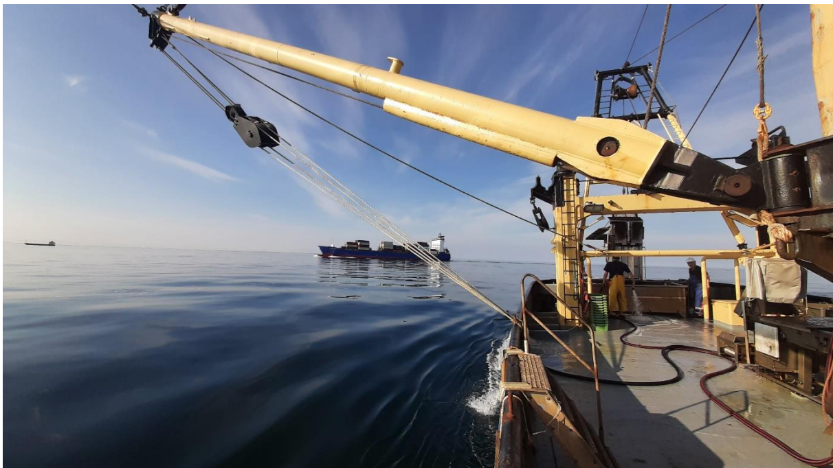
Figuur 10. Bij de bemonsteringen in de kustzone met de Isis komt een gladde zee soms ook voor. Op het achterdek wordt met behulp van het A-frame de bodemschaaf binnengehaald.
