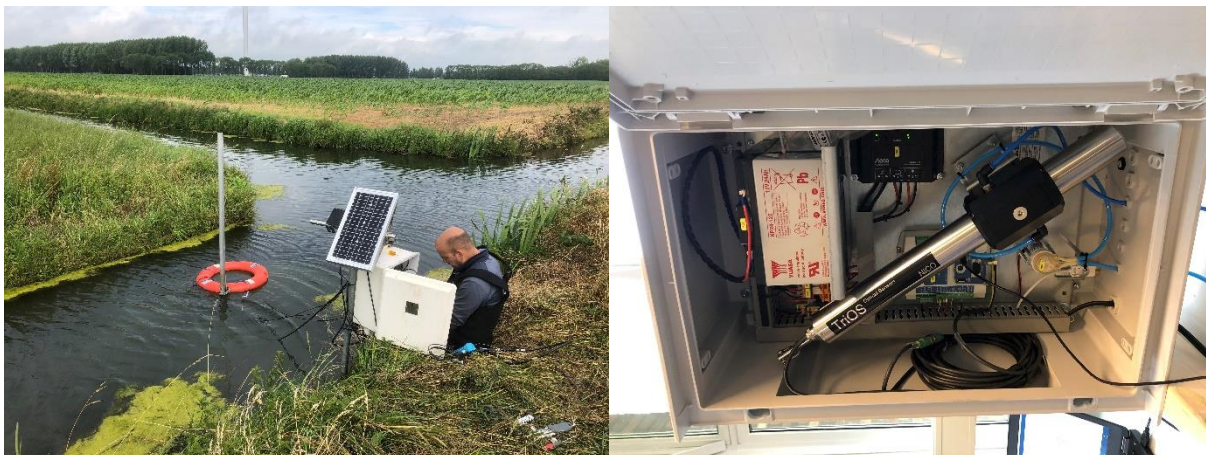
Afbeelding 1. Een aantal meetopstellingen - linksboven: sensor in beschermkoker met zonnepaneel [4], rechtsboven: sensor in een doorstroombassin in een meetcabine [3], linksonder: sensor op een boei [2], rechtsonder: sensor in een doorstroomcel [2]
