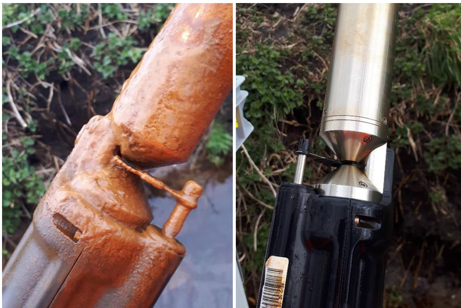
Afbeelding 2. Een UV-nitraatsensor met vervuiling in een ijzerrijke kwelsloot in een zandgebied [4]. De wisser is niet krachtig genoeg om de aangroei weg te halen en veroorzaakte daarbij krassen op de lenzen (links). Rechts na schoonmaak van de sensor
