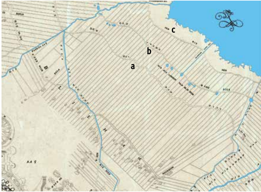
Figuur 1 Kaart van Anthoni Brunij over de bedijkingen van de aanwassen uit 1590. De eigeners van Winschoten begonnen met het leggen van de eerste dijk (a) tussen 1528 en 1530 bij Winschoten. In 1544 werd de tweede oude dijk (b) aangelegd en in 1579 de 'nie dick' (c). (Door Ruut Wegman digitaal overgetrokken van het vrijwel onleesbare origineel.)
