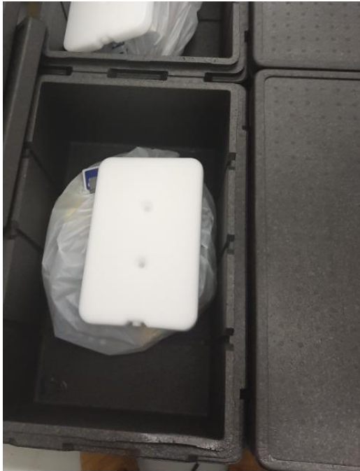
Figuur 4: Meting met temperatuur met LogTag logger aan de onder en bovenzijde van de plastic tas (foto: WFBR)
