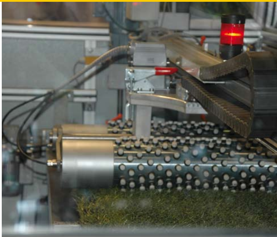
Testen van vervorming en de slijtweerstand van kunstgras met de Lisport-tester
