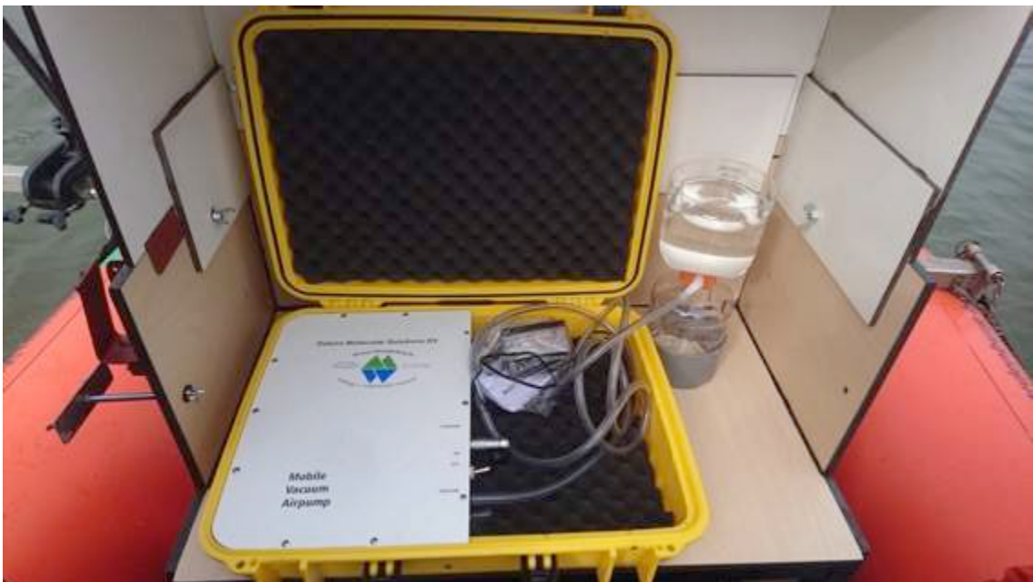
Foto 2.2. Filtreeropstelling aan boord van onderzoekvaartuig.
