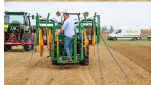
Met de tapelegmachine kun je per dag 6 tot 8 ha ondergronds druppeldarmen trekken. Na de oogst kan je tape uit de grond halen met een machine met twee loopwielen die hydraulisch bediend worden.
