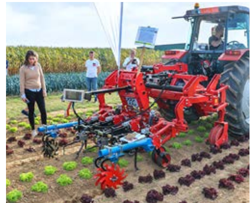
De K.U.L.T. iSelect-schoffelmachine werkt volledig automatisch en is eenvoudig te bedienen.
