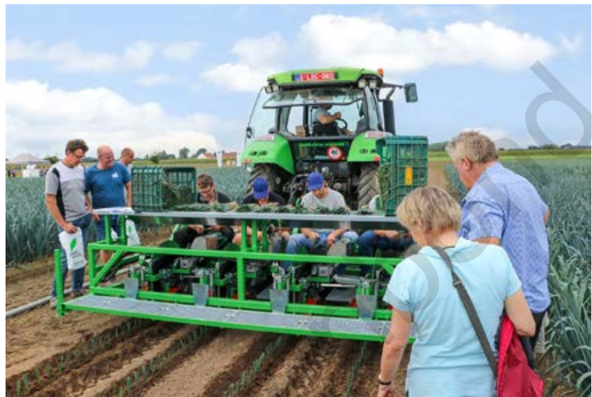
Op de schijfplantmachine van Basrijs worden de preiplanten in de smalle plantgeul losgelaten en daarna stevig aangedrukt voor een vlotte weggroei.
