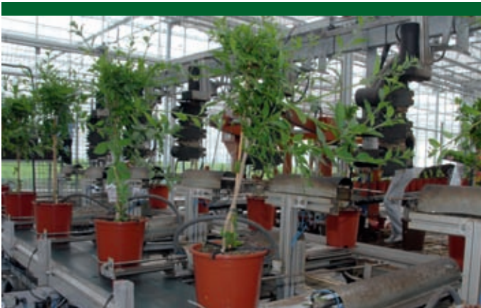
Het apparaat heeft bij Kwekerij de Barreveld zes frames met trimmers zodat ze zes planten tegelijk kunnen snoeien.
