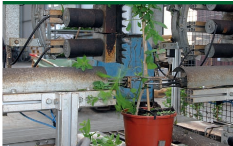
De vormsnoeimachine zorgt ervoor dat iedere plant dezelfde vorm krijgt. Bovendien bespaart het de kweker vijf medewerkers.
