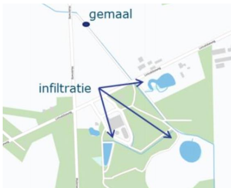
Figuur 3 Wateraanvoer en infiltratie van Berkelwater bij pompstation Olden Eibergen
