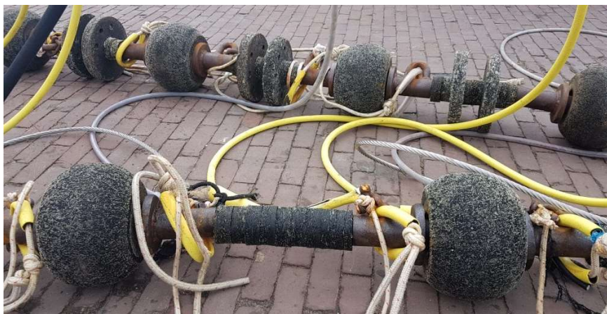
Figuur 1: voorbeeld van de huidige klossenpees van WR40 (onderaan) en de experimentele met extra schijven (bovenaan).
