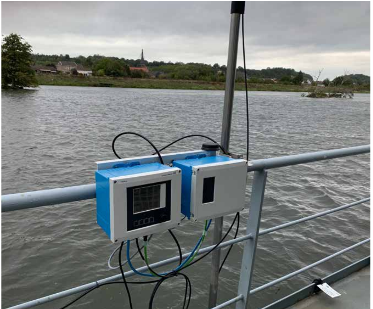
Foto 1: De Maas bij Eijsden gezien vanaf het meetplatform. De meeste sensoren zijn aan de reling bevestigd en direct in de Maas geplaatst
