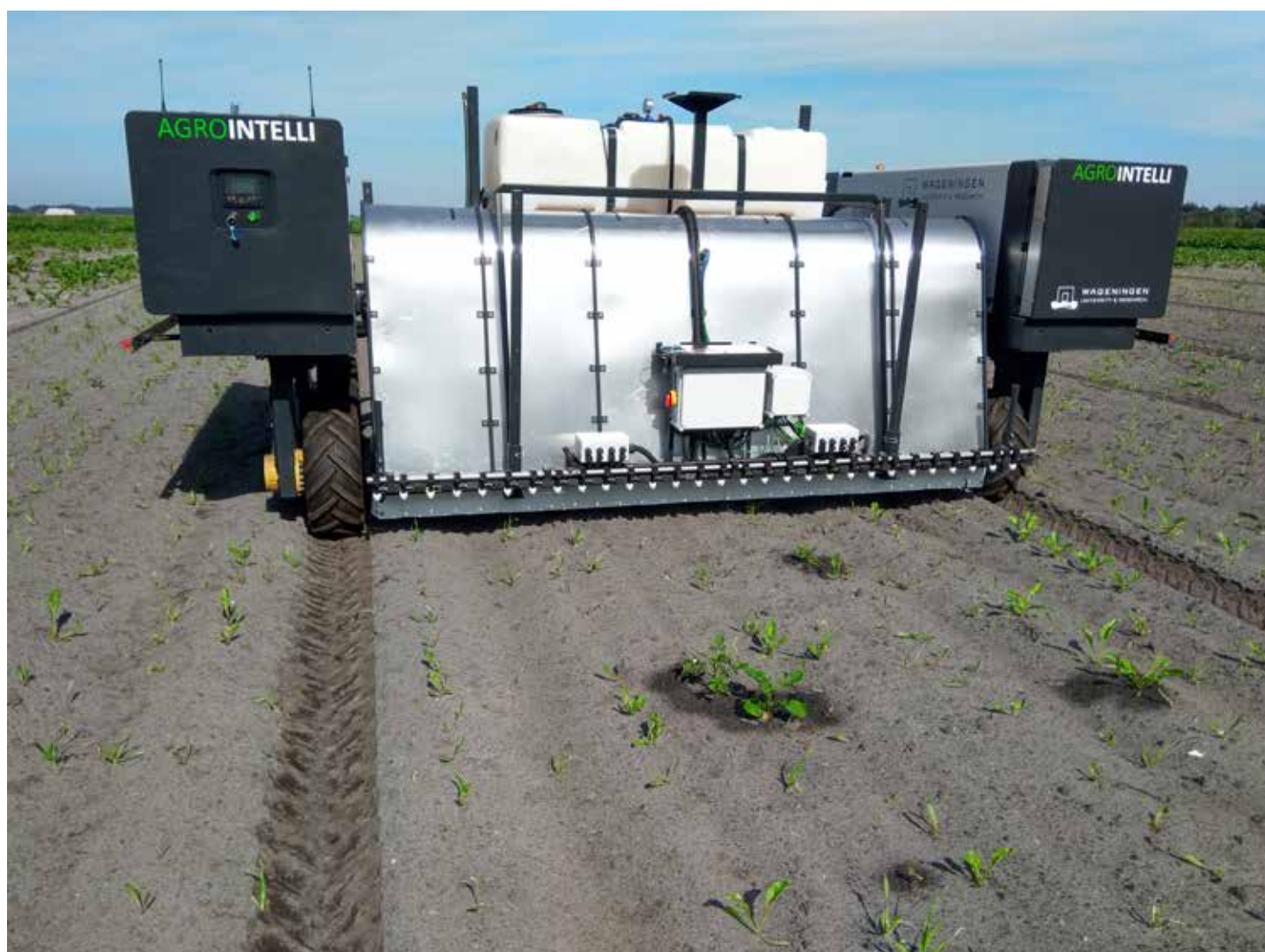
Robot met spotsprayer spuitje om plaats specifiek onkruid te herkennen en aan te pakken. Ook schoffelrobots (zie omslag) worden al ingezet (foto: project NPPL/BvdT).
