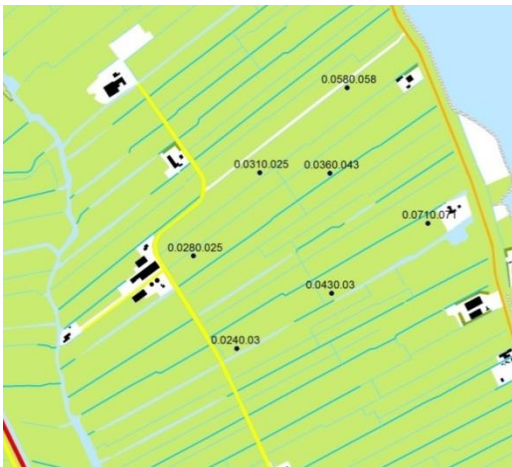
Figuur 6 Gemeten k-waarden met de boorgatmethode 8 juni 2012.
