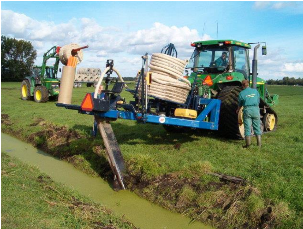
Figuur 3.5 Draineermachine met een halve V-ploeg van loonwerkbedrijf De Vlijt uit Noord-Beemster, waarmee sleufloos gedraineerd werd.
