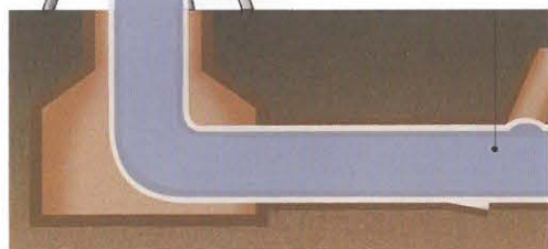
Inbrengen flexibele kous, die daarna wordt gevuld met water. De waterdruk keert de kous binnestebuiten in de oude buis.
