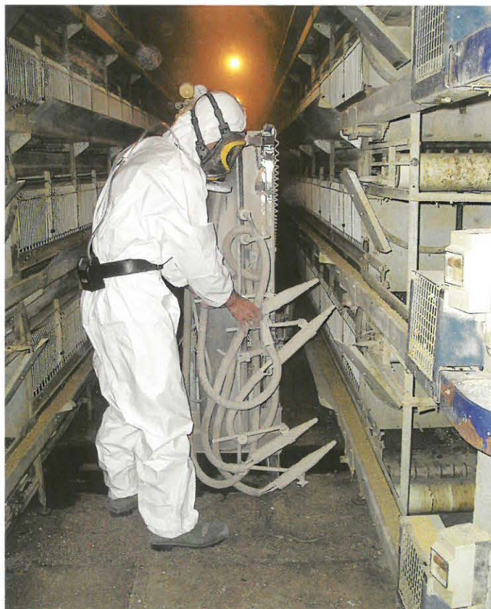
U5 wordt in de legbatterij aangebracht met behulp van een elektrostatiche wagen, waarbij met diverse spuitpistolen tegelijkertijd het middel op het front van de kooi wordt aangebracht. Ook kan men met een enkelvoudig pistool werken. Foto: Denka.
