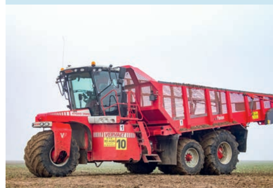
Een overlaadwagen geschikt voor veldtransport met brede, lagedrukbanden
