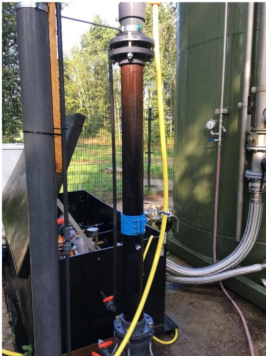
Afbeelding 3. Kolomproef actiefkoolfilter op het ruwe grondwater van bron 39
