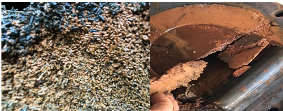
Afbeelding 8. Fe(OH)_3 op kool en mangat van het filter op bron 39
