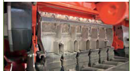
De machine heeft vier van deze doseerunits. Elke doseerunit heeft zes nokkenraden, voor elke uitstroomopening één.
