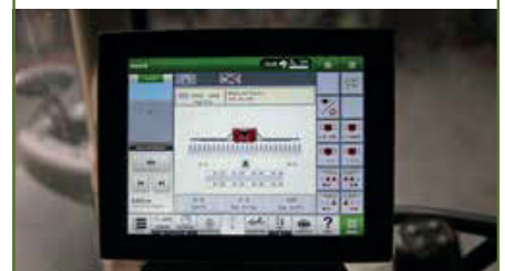
De bediening loopt via een Isobus-terminal. Hierop kan ook de sectiecontrole draaien en kan via taakkaarten worden gestrooid.
