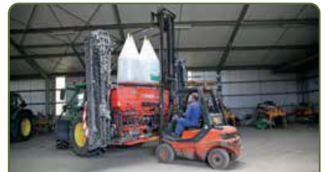
Bij het laden van de machine gaan de bomen hydraulisch naar de zijkant. Zo ontstaat er voldoende ruimte om vanuit big bags te laden.
