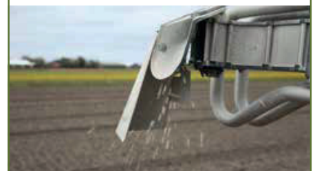
Het ketsplaatje wordt voor bijbemesten omgedraaid, zodat de korrels omhoog gaan. Het kantstrooiplaatje begrenst het strooibeeld.
