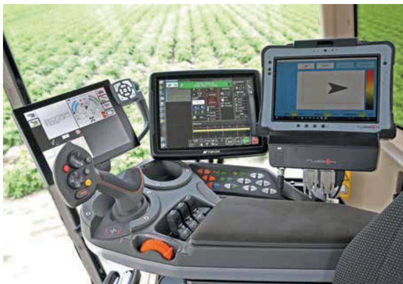
De chauffeur heeft in de cabine drie beeldschermen. Vanaf links het scherm van de Rogator, dan het Topcon-scherm voor spuit en GPS en ten slotte het scherm voor de bediening van de Optimiser.
