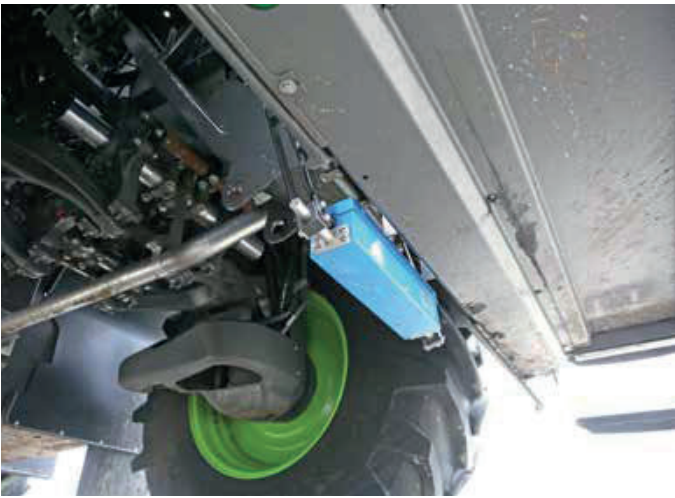
De Optimiser-scanner is in een blauwe behuizing voor onder de Fendt Rogator gebouwd. Hij kan met 20 km/u scannen en de Rogator kan tegelijk de meststof doseren.
