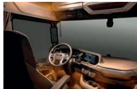
De nagenoeg vlakke cabinevloer van de nieuwe XF staat 75 millimeter lager dan bij de huidige XF Space Cab. In combinatie met een grote voorruit en lagere ruitlijnen is er meer direct zicht.
