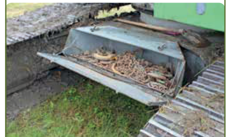
Opbergruimte voor gereedschap is er genoeg. Schadenberg liet aan de onderwagen een kist monteren voor de hijskettingen.
