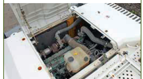
In alle uren die de kraan was ingelogd (9612,2 uur), gebruikte hij in totaal 99.100 liter diesel. Gemiddeld is dat dus slechts 10,3 liter per uur.
