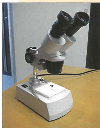
Deze stereomicroscop heeft opvallend en doorschijnend licht. Dat maakt hem ook geschikt om preparaten te bekijken.
