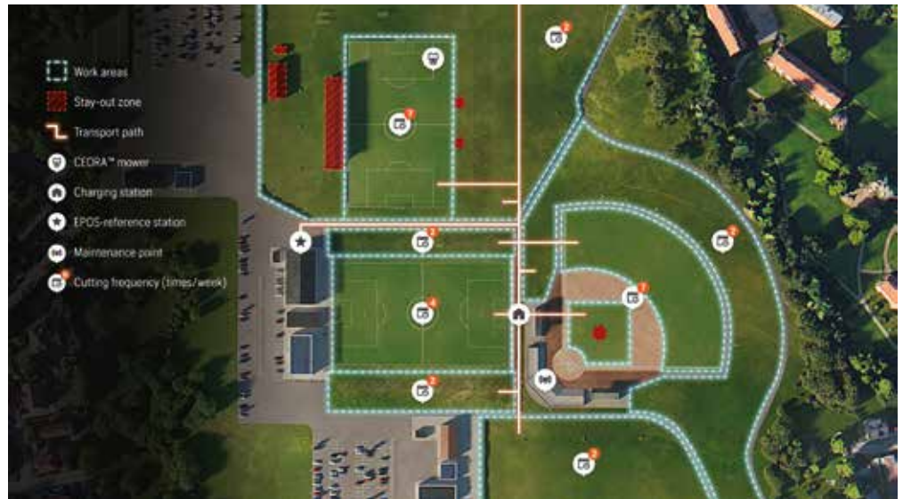
Een voorbeeld van de inzet van de Ceora met laadpunt, basisstation en routing naar de verschillende te maaien percelen.
