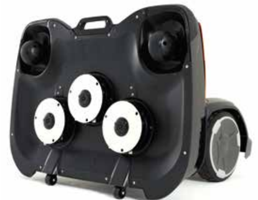
De maaier heeft drie rotors met dunne mesjes voor het beste maaieresultaat. Voor het frequent wisselen van de schijven met mesjes is een snelwisselsysteem ontwikkeld.
