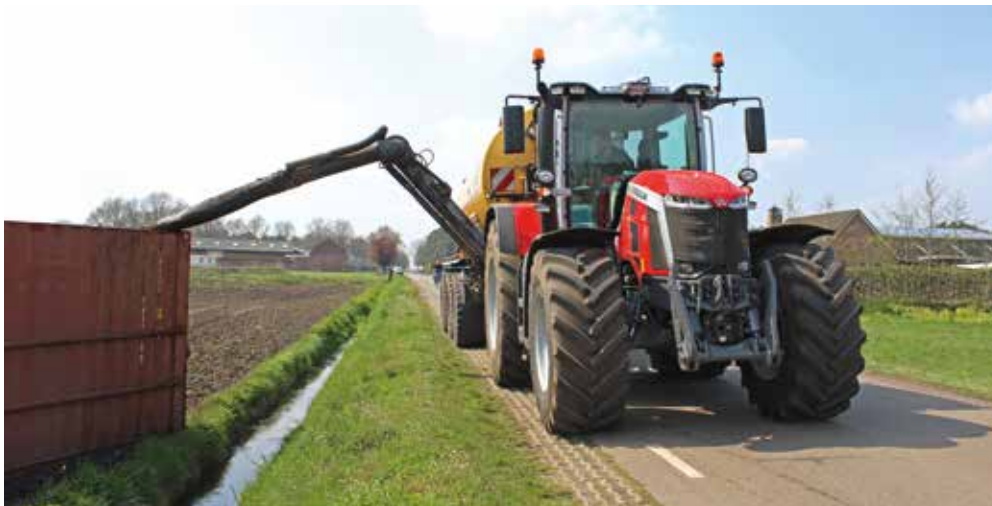
Door de zuigarm hoefde de chauffeur zowel bij het laden als bij het lossen niet uit de trekker te komen. De 8S.265 draaide dan ook maar twee procent van de tijd stationair.
