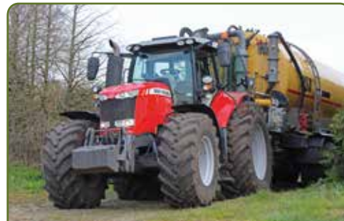
De vier jaar oude Massey Ferguson 7724 heeft ruim 5200 uur op de klok en maakt gebruik van nagenoeg hetzelfde 7,4-liter Agco Power-blok, maar dan in Stage IV-uitvoering in plaats van Stage V. Hij heeft 19 kW (25 pk) minder dan merkgenoot 85.265.
