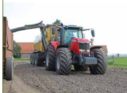
De chauffeur op de Massey Ferguson 7724 maakte een dag van ongeveer drie kwartier korter en deed negentien vrachten van 30 kuub, ofwel 570 kuub. Daarvoor had de trekker evengoed 402 liter brandstof nodig.
