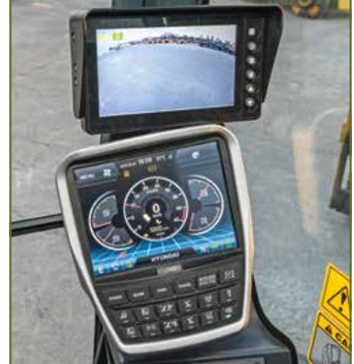
Het Hyundai AAVM-rondomzicht-camerabewakings-systeem herkent bewegende objecten binnen vijf meter en waarschuwt de machinist.
