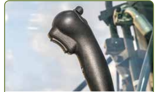
Het vooruit-achteruitrijpedaal is vervangen door een FNR-schakelaar achter op de rechter joystick.
