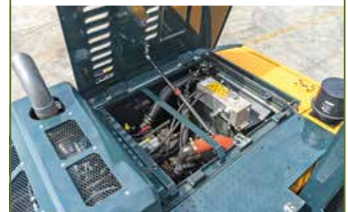
De serie is uitgerust met 4,5-liter-Cummins-Stage V-viercilindermotoren. Deze zijn compacter en mede daardoor zijn de machines ook korter geworden.
