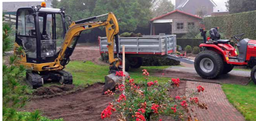
Frank voert desgewenst ook bijkomende grondverzetklussen uit. Hiervoor heeft hij een tweetons minigraafmachine in combinatie met een compacte gronddumper.
