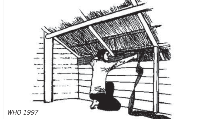
Het afdichten van de ventilatieruimten met zogenaamde "eave curtains" (in de tekst horren genoemd).
