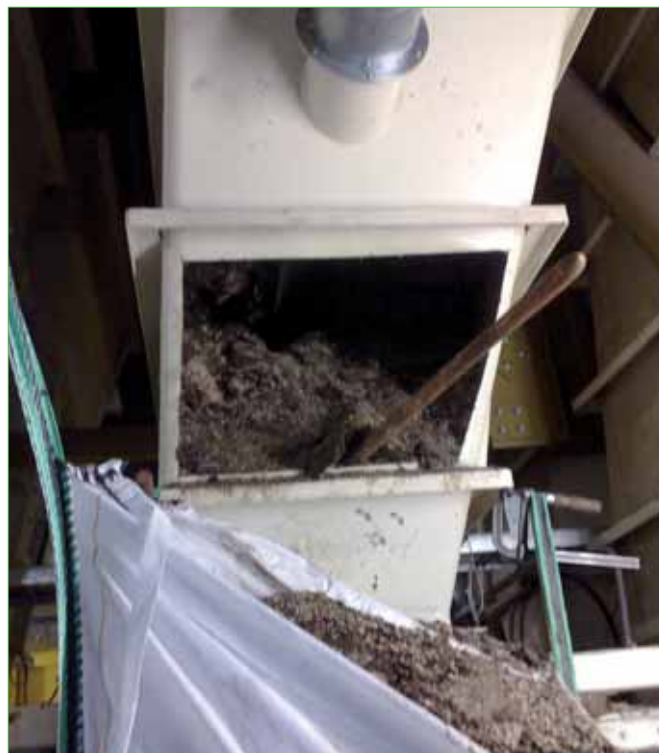
Sanering bij de bron: de desinfectering van de lege silo, inclusief leidingwerk, voorkomt voorraad aantastende insecten bij bulkopslag (siloreiniging conform GMP richtlijn voedingsmiddelen industrie).
