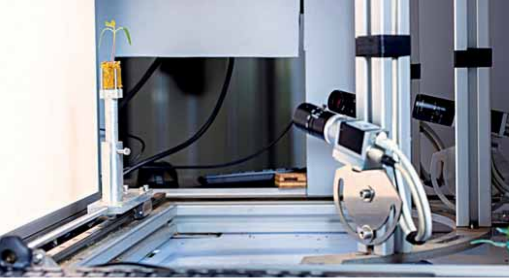
Foto: de Marvin maakt vanuit verschillende hoeken foto's van een plantje waardoor een 3D-beeld ontstaat
