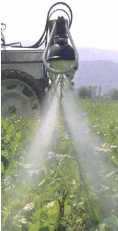
Figuur 1. Spuitkegel van een dubbele spleetdop (TJ60-110.04VS).
