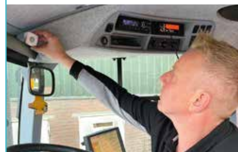
Een andere mogelijkheid is het installeren van bewegingssensoren in de trekker in combinatie met plaatsbepaling van het Lora netwerk.
