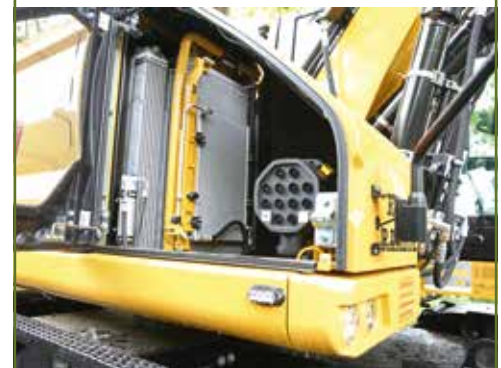
Het nieuwe luchtfilter is heel compact. Daarom kon de beplating sterker aflopen en is het zicht naar rechts beter.
