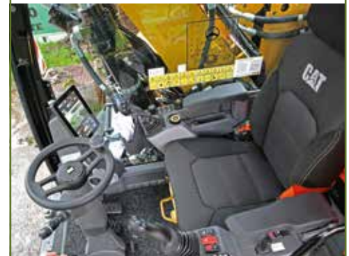
De cabine is fors vernieuwd. Hij werd stiller en het zicht is beter. De joysticks en pedalen zijn allemaal elektrisch bediend.
