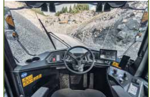
De cabine kreeg een veel groter glasoppervlak. Het zicht naar voren verbeterde verder door een nieuw dashboard en de schuin aflopende motorkap.
