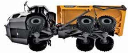
De machine heeft met name aan de voorkant meer bodemvrijheid. Het gegoten knikstuk is een stuk zwaarder dan het oude.
