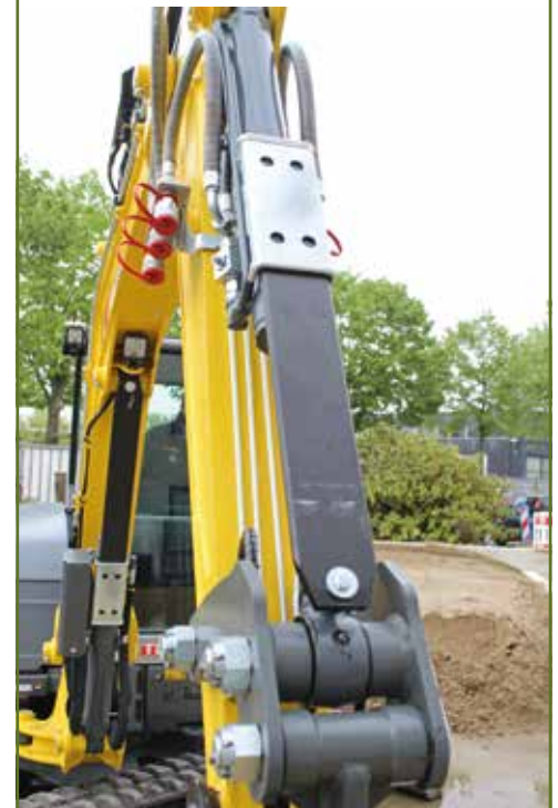
Om de hydrauliekcilinders van hefarm, lepelsteel en bakcilinder te beschermen, is er geen staal maar kunststof gebruikt, om gevolgschade te voorkomen.
