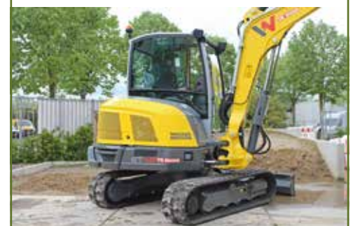
Bij de Stage V-modellen zijn de schijnwerpers rondom geïntegreerd in de onderwagen.
