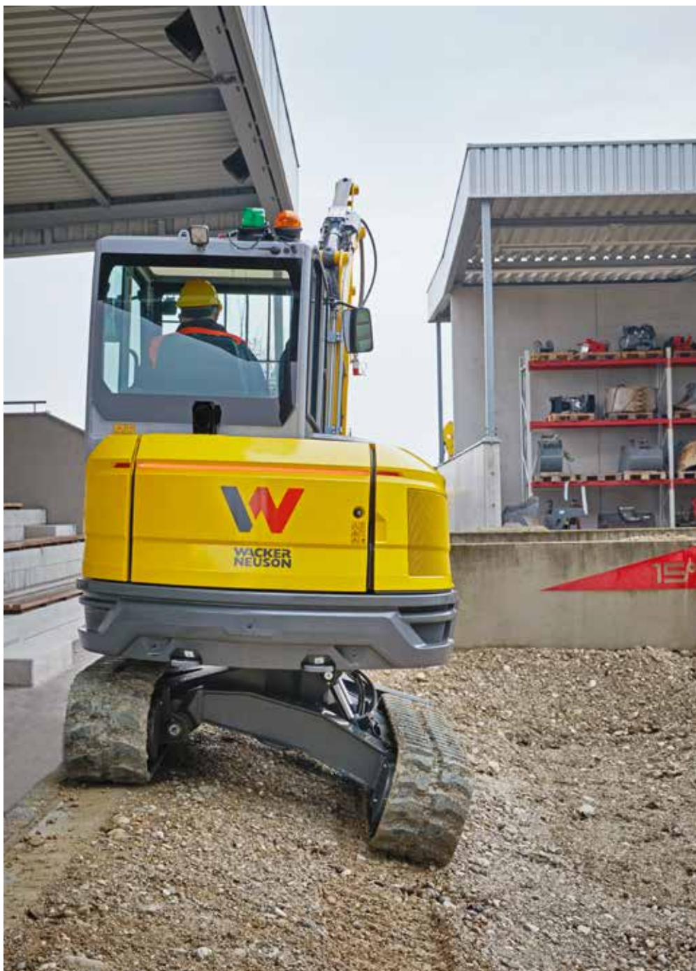
Het VDS kan de onderwagen in een hoek van vijftien graden met de bovenwagen zetten voor recht graafwerk.
