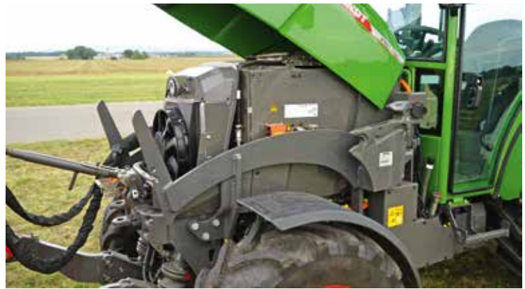
Bij trekkers is het grote probleem dat er onder de motorkap nauwelijks ruimte is voor het batterijpakket.
